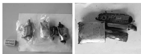
ごみ処理場において発火・火災を誘発した電子タバコ
