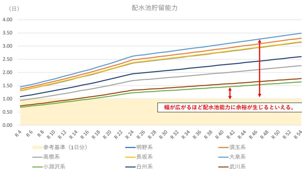
図 3-4 配水池貯留能力の見込み
