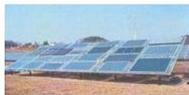
同条件でPVモジュール特性評価（9カ国24種類）
